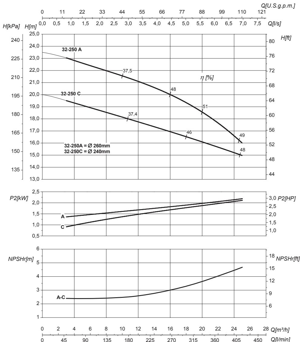
**DN nominale aspirazione • DN suction • DN Aspiración • DN aspiration • DN Ansaugstutzen • Номинальный DN всасывания**
